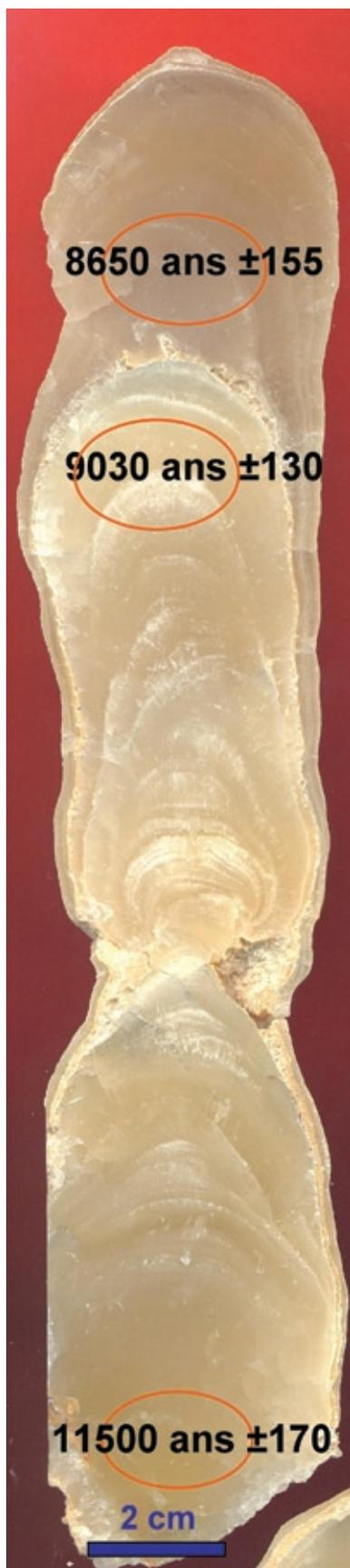
**Photo 5** – Section polie verticale de la stalagmite Chau-stm8 avec les âges U/Th. Les cercles orange correspondent aux échantillons prélevés.
