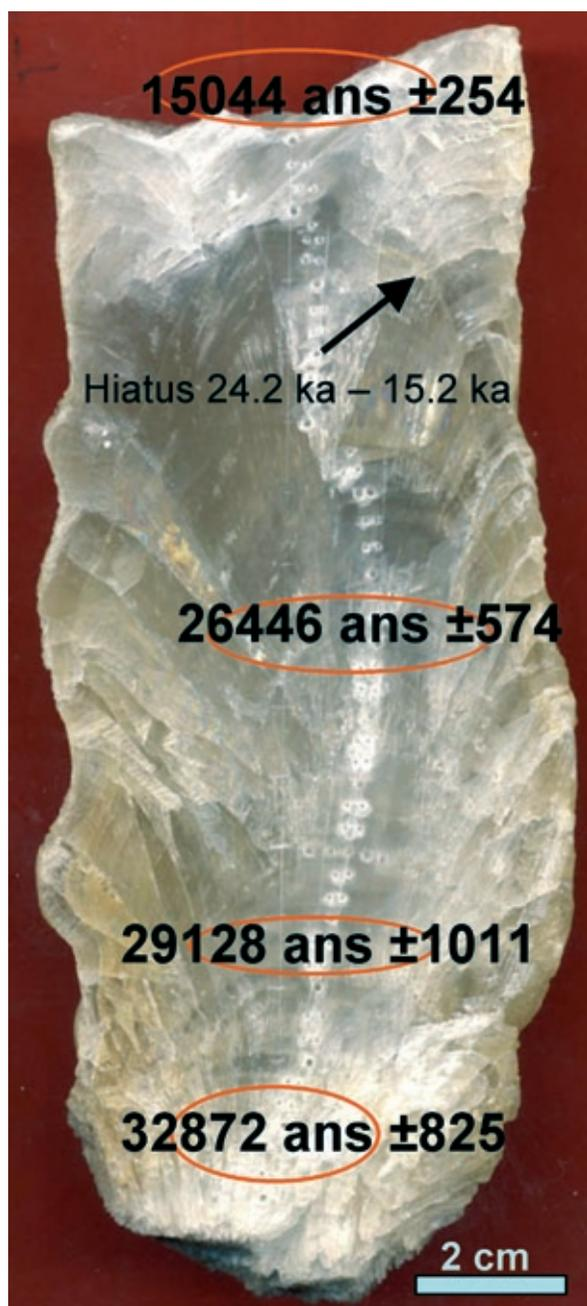
**Photo 12** – Section polie verticale de la base de la stalagmite Chau-stm6 avec les âges U/Th. Les cercles orange correspondent aux échantillons prélevés. Le hiatus de croissance entre 24,2 ka et 15,2 ka apparaît comme une fine couche brune. Les trous le long de l'axe de croissance correspondent aux échantillons prélevés pour les analyses d'isotopes stables.
